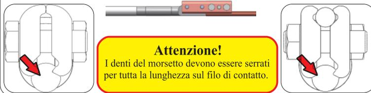
8. Serrare solo le viti di fissaggio del giunto (che tengono il filo di contatto) a **50 Nm**. Ripetere questa procedura due volte (fino a che ogni vite sia stata stretta per un totale di 3 volte).
