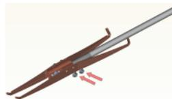
13. Regolare le sciabole (spingere manualmente verso l'alto) e serrare le viti a **40 Nm**.
