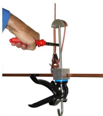
**8.** Pressare il manicotto con la pinza a compressione manuale (tipo DB 10 K) fino al completo serraggio.
