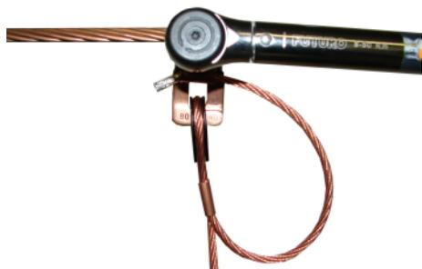
2. Fissare il morsetto al filo di contatto e serrare la vite a 25 Nm.
