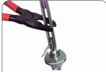
Contrôler encore tous les contre-écrous. Contrer les tendeurs avec contre-écrous.
