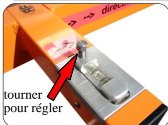
Positionner le JIG avec côté rouge en direction de l'installation. Régler le niveau à bulle pour le côté rouge.
