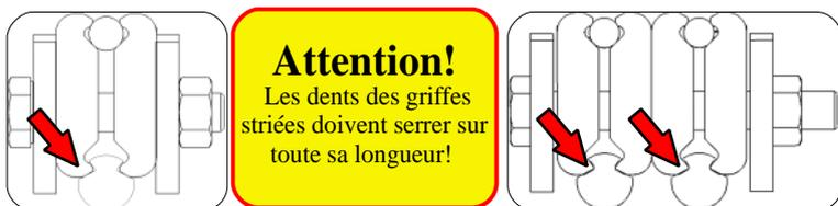
Serrer les vis des griffes striées avec **50 Nm** en utilisant une clé dynamométrique et resserrer **3 fois**.
