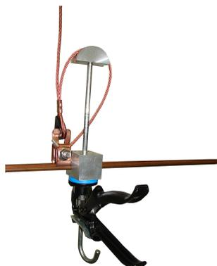
6. La longueur du pendule à câble peut être ajustée avec l'outil spécial. Contrôler la hauteur du fil de contact.
