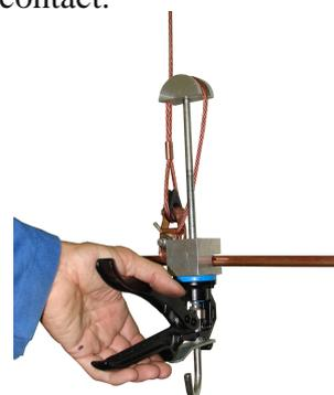
7. Presser vers le bas jusqu'à la douille de serrage.
