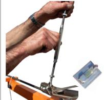
Feineinstellung Achten Sie auf die Wasserwaage auf dem JIG, wenn Sie an den Spannschlössern das Niveau des Trennerkörpers einstellen.
