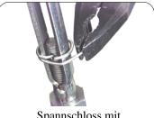
Spannschloss mit Sicherungsdraht fixieren.
