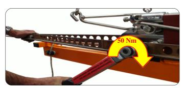
14. Muttern mit 50 Nm anziehen und mit zweiter kontern
