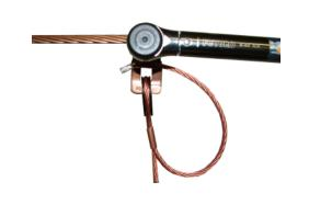
**2.** Befestigen der Seilhängerklemme am Fahrdraht. Anziehen der Schraube mit 25 Nm.
