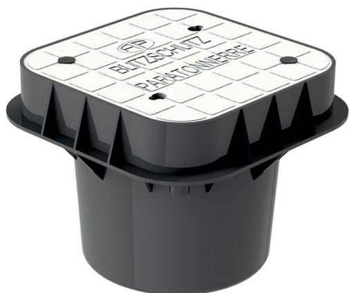
La chambre de contrôle est destinée au montage à l'extérieur (pleine terre, pavés ou béton) sur terrain privé, selon EN62561 -5. En fonction de l'enrobage, pleine terre, gravier, béton **a** – la capacité de charge max. est de 5000 kg.
